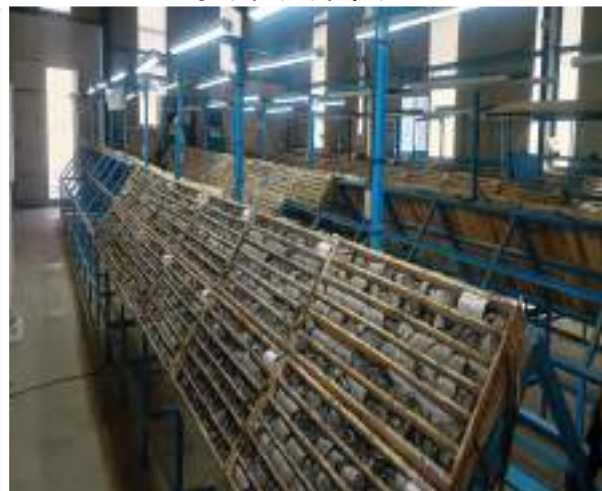
نمونه برداری از مغزه‌های حفاری
